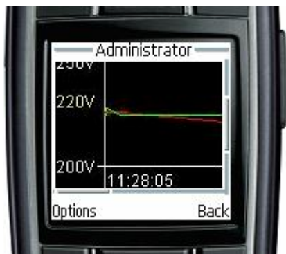
Sl. 5. Grafik zavisnosti ulaznog i izlaznog napona od vremena na WAP browseru mobilnog telefona
